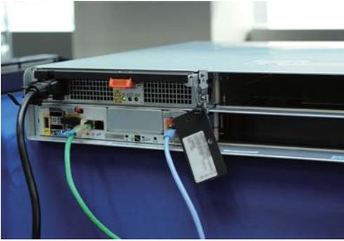
写真3 背面のストレージプロセッサモジュールと電源モジュールを冗長構成で導入できる
