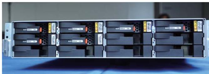
写真2 2Uの3100では合計12台の3.5インチHDDを収容できる
