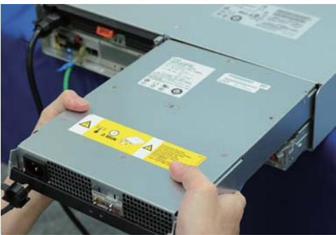
写真5 電源モジュールも冗長構成をとれ、ホットスワップでの交換が可能
